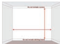
۱- اندازه‌گیری محدوده دیوار برای رنگ‌آمیزی شکل ۲۰-۵
